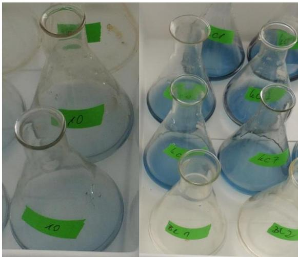
**Abbildung 4.1.2-1** Proben von in Königswasser aufgeschlossener Knochenkohle (KC) im Konzentrationsbereich 6-9  $\mu\text{M}$  (1:10 verdünnt) mit viel zu starker Blaufärbung. Auch diese Aufschlüsse wurden nicht neutralisiert und in PE-Röhrchen gefroren gelagert. Unten Blindwerte, links 10  $\mu\text{M}$  Phosphatstandards ohne Aufschluss.
