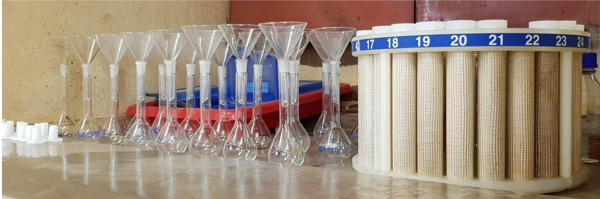
**Abbildung 4.1.2-3** Maßkolben mit Trichtern zum Abfiltrieren des Bodens (Proben)gefäße der Mikrowelle in Berstschutzhüllen (MarsXpress)
