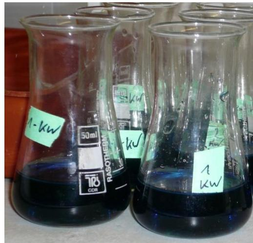
**Abbildung 4.1.2-2** Nicht neutralisierte Blindwerte (Aufschluss in neutraler Persulfatlösung), die über Nacht in PE Zentrifugenröhrchen gelagert wurden und deren Blaufärbung extrem hoch war. KW: Kraftwerkswasser (sehr sauberes, P-freies Reinstwasser aus dem Kraftwerk Rostock)
