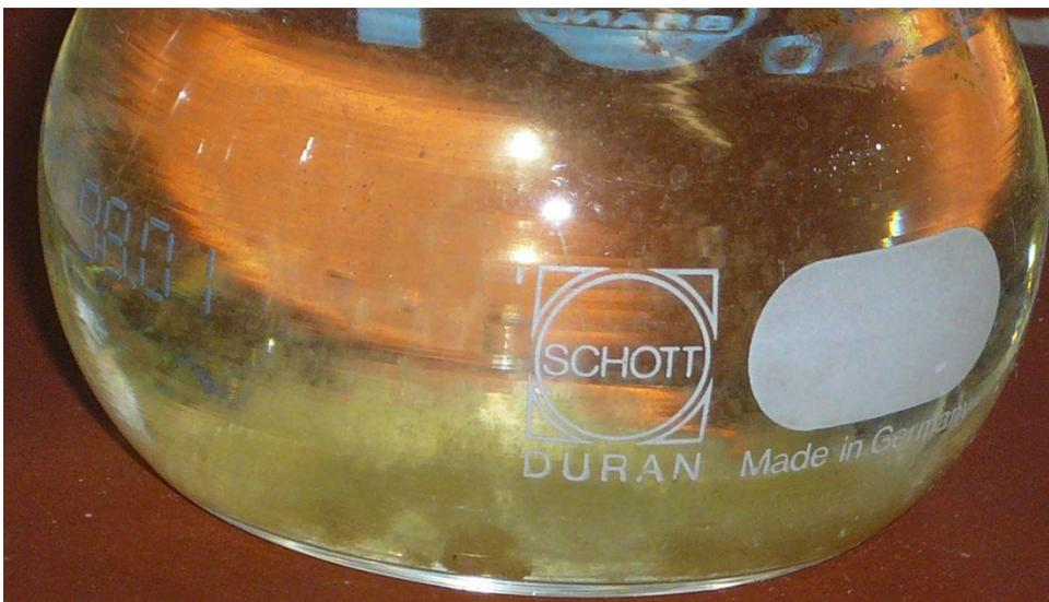
**Abb. 4.4.1-1** Ausfällung des Ferrihydrits nach dem Aufschluss einer eisenhaltigen Probe
