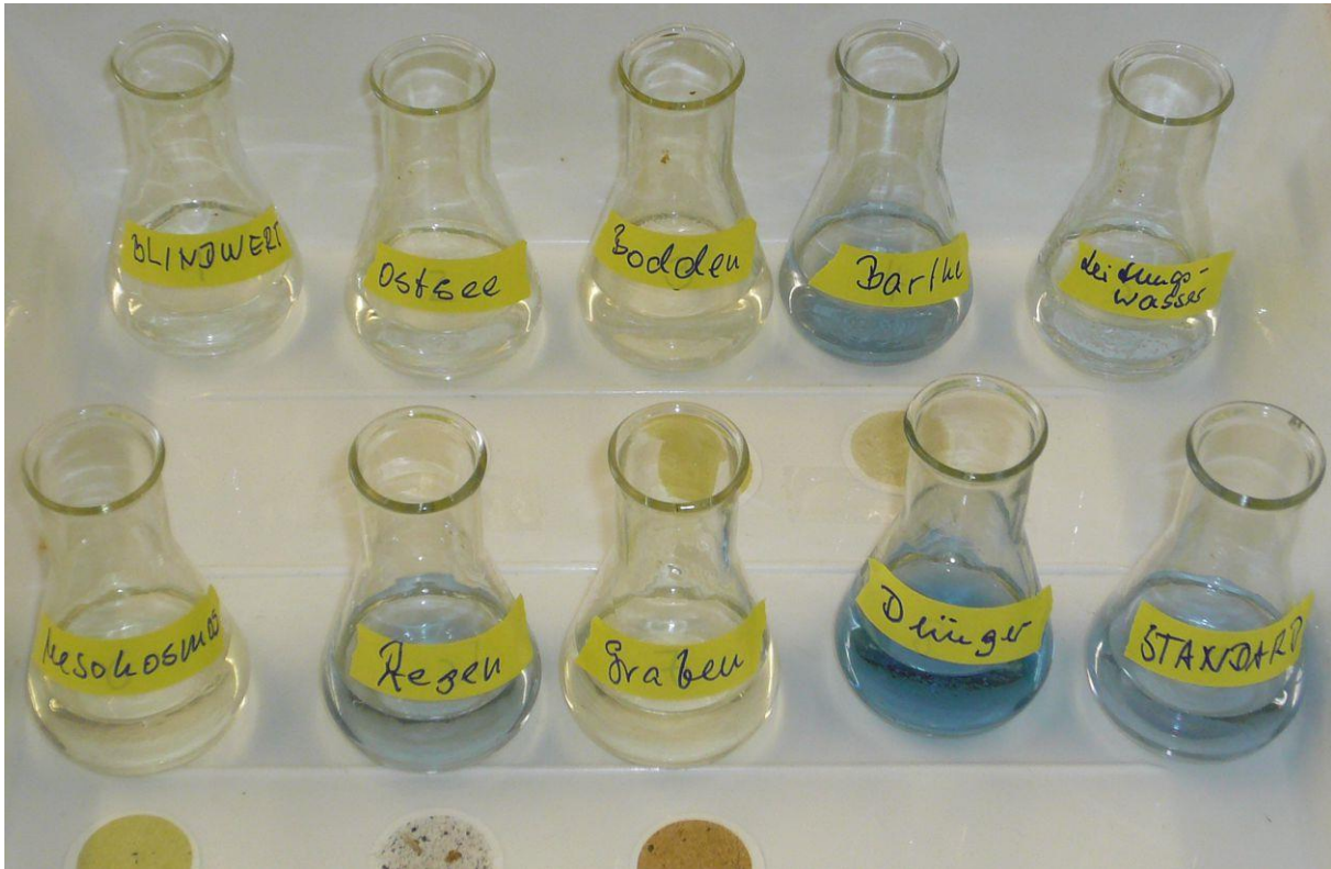
Abbildung 5.2.3-1 Erlenmeyerkölbchen mit verschiedenen phosphathaltigen und phosphatfreien Proben (Molybdänblau, Standard= 5 \mu\text{M} ). Die Filter sind durch das abfiltrierte Seston teilweise sehr stark gefärbt.
