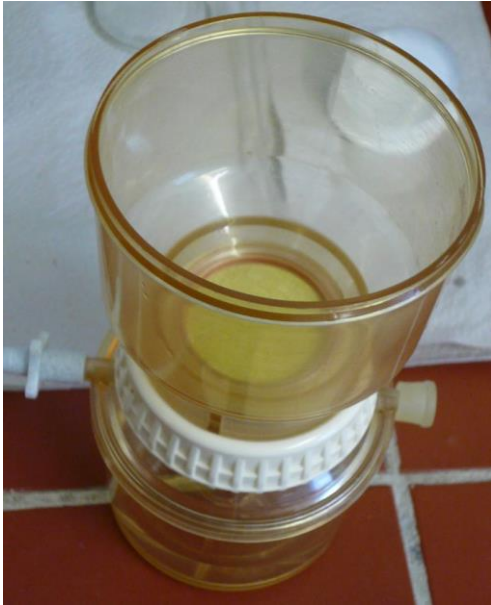
Abbildung 5.2.3-2 a Filtriergestell mit Filter (GF 6, 47 mm). Anschluss an Pumpe (-200 mbar Druck) links.
