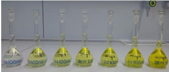
**Abbildung 5.2.5-3 a** Kalibrantenreihe von Vanadomolybdägelb in einer Doppellactat-Extraktionsmatrix
